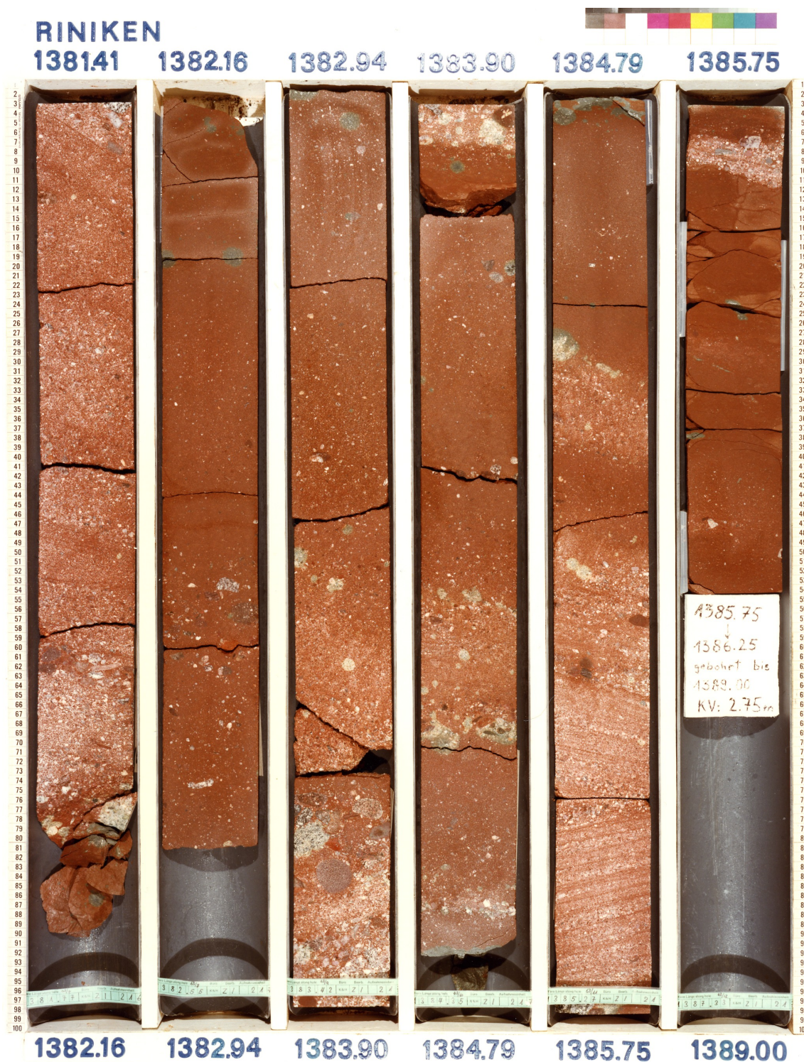
Fig. B-2: Bohrkern aus einem Abschnitt zweier Testintervalle in der 'Zyklischen Kristallinbreccien Serie' im Rotliegenden (1373.8 – 1384 m und 1384 – 1394.2 m Bohrtiefe) der Tiefbohrung Riniken.
