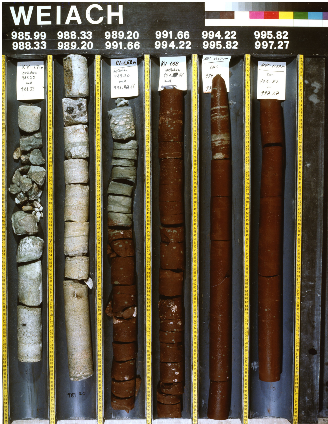
Fig. B-1: Bohrkern aus einem Abschnitt des Testintervalls im Buntsandstein (981.4 – 990 m Bohrtiefe) der Tiefbohrung Weiach (KV = Kernverlust).
