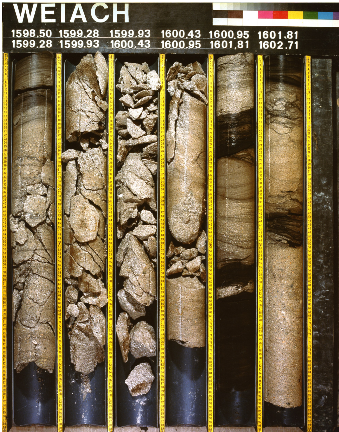
Fig. B-3: Bohrkern aus einem Abschnitt des Testintervalls in der 'Kohle-Serie' im Oberkarbon (1593 – 1613.2 m Bohrtiefe) der Tiefbohrung Weiach.
